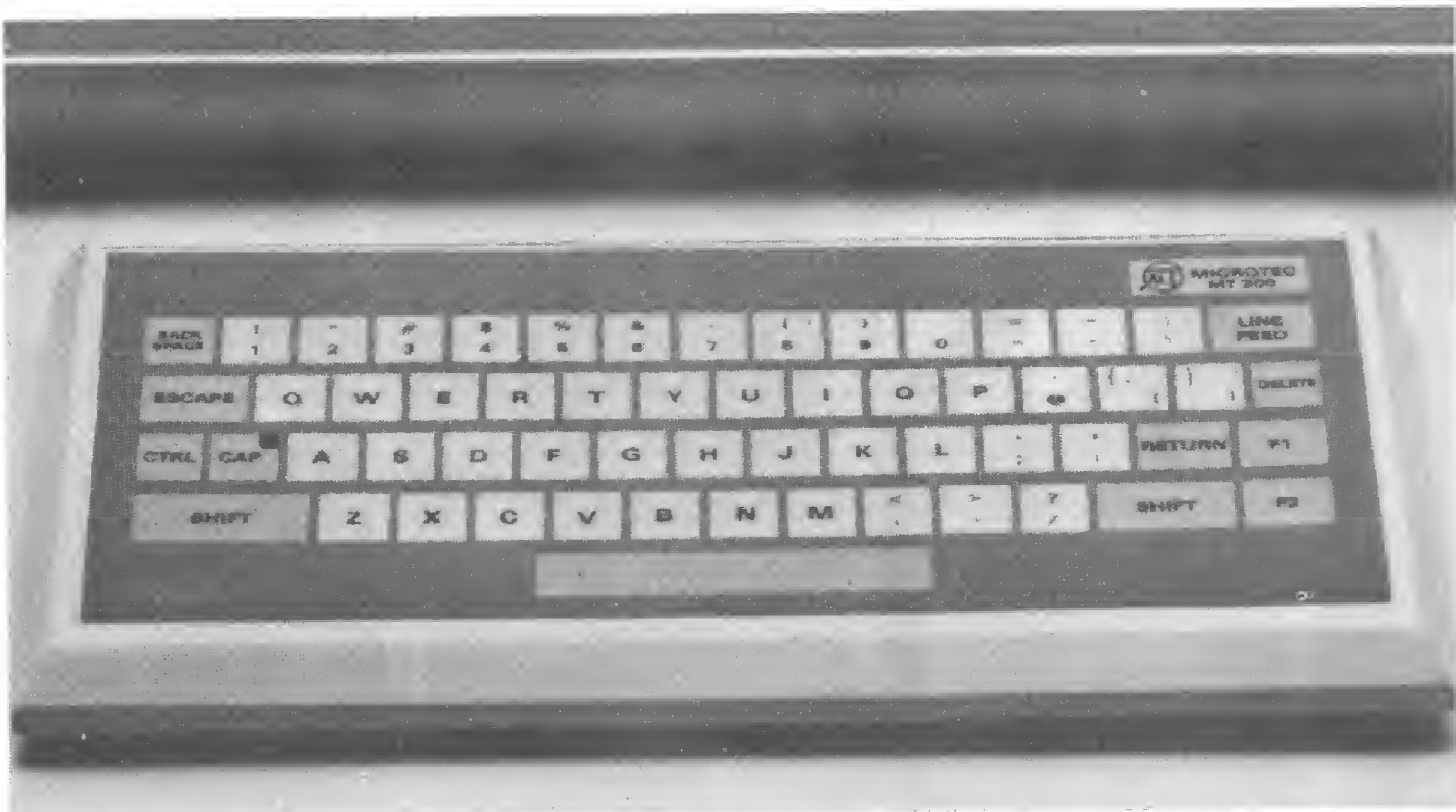
O MT-300 utiliza o teclado de membrana flexível MT-200, que também é comercializado separadamente.
